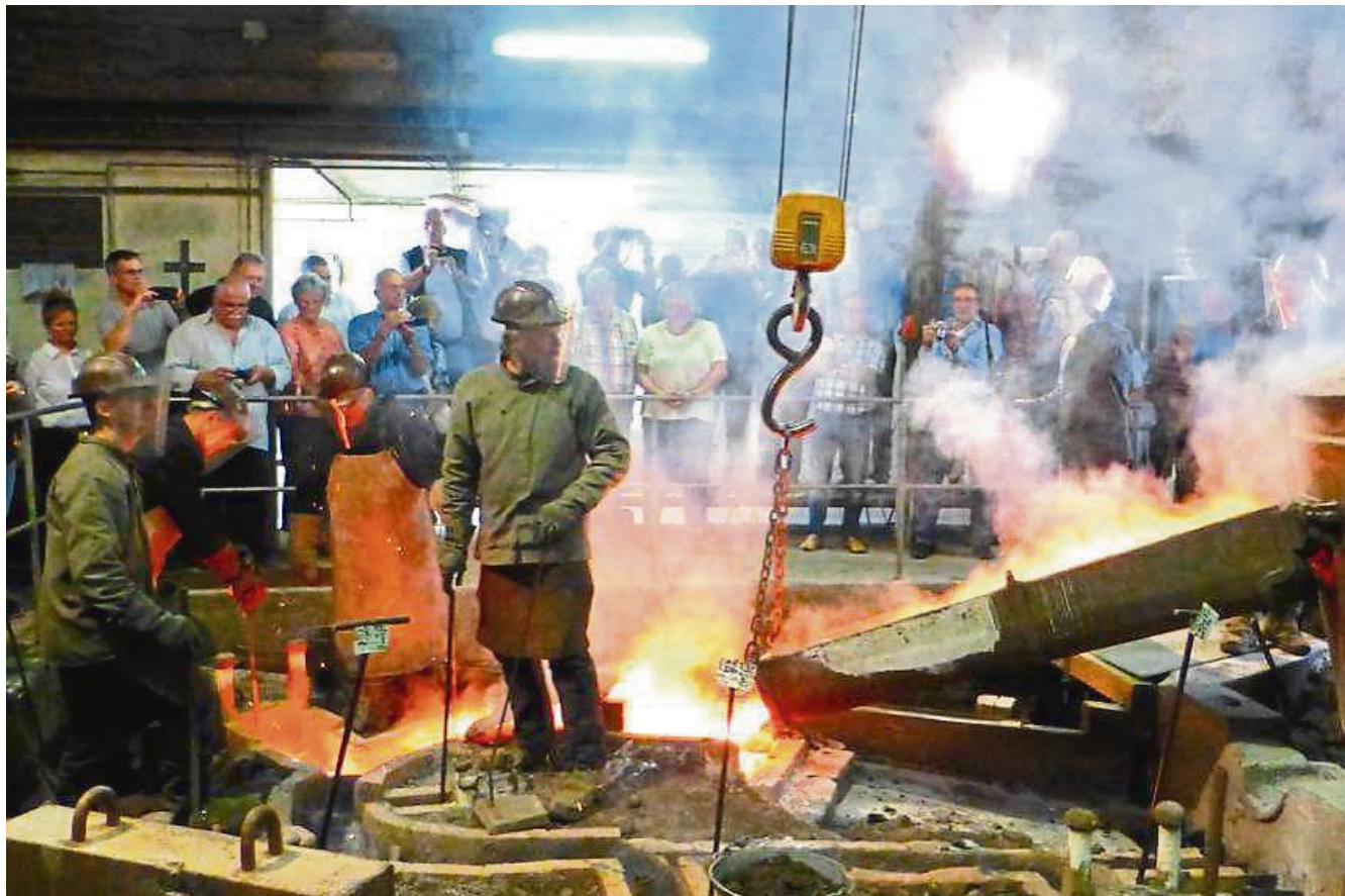
Ruhe im Augenblick des Gusses: Die Berger schauen zu, wie das Kupfer-Zinn-Gemisch in die Formen rinnt. Die Arbeiter hören und spüren, wann die Form voll ist. Die Glocken haben eine Lebensdauer von 300 Jahren.
